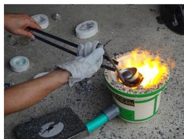
2学期の始業式では、「夏休み何した？」ということで、私が夏休みに挑戦したことについてのお話をしました。写真は、アルミニウム鋳造の様子です。アルミ製の空き缶を潰し、七輪を「炉」代わりに、ドライヤーで炭火に風を送って火力を上げて溶かします。とても熱くなる作業ですので夏場は大変です。冬場になったら、6年生の子どもたちと、この方法での作品作りができたらと考えています。
