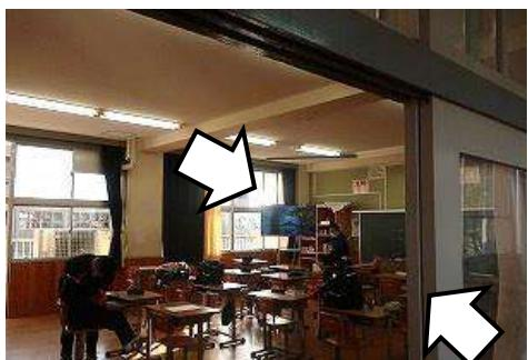
★対角線上の窓を開けると、空気の流れができ効率的に換気ができます。
