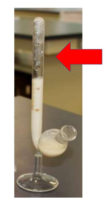
この実験器具で糖の発酵性を調べた。矢印で示した部分に発生した気体を化学式で答えなさい。
