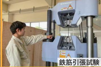
鉄筋引張試験
