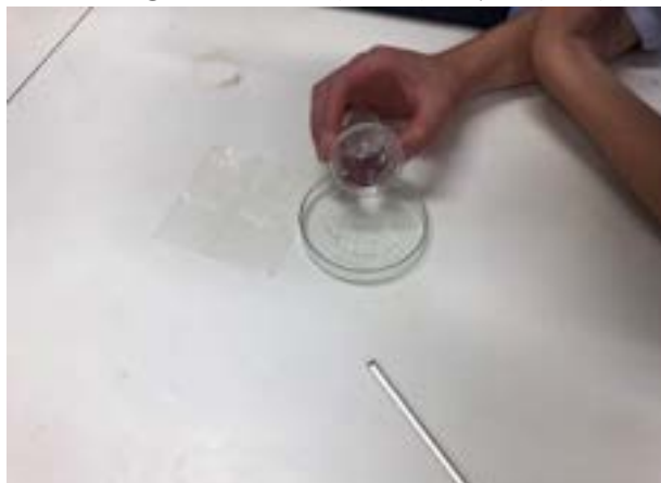
図 ①-1 酢酸ナトリウムを用いた過飽和溶液の結晶化
