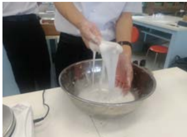
図 ①-2 片栗粉を用いたダイラタンシーの実験
