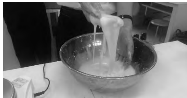
図 ①-2 片栗粉を用いたダイラタンシーの実験
