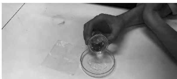
図 ①-1 酢酸ナトリウムを用いた過飽和溶液の結晶化
