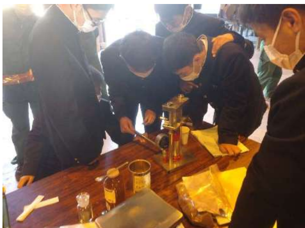
図④-3 持参した添加物を入れたバークを錠剤へと成形する過程
