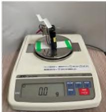
電子天秤にプロペラを上向きに配置し、モーターの駆動による質量の差を測定する。この実験値はプロペラの推力として考えることができる。10秒間の数値の平均値を算出する。
