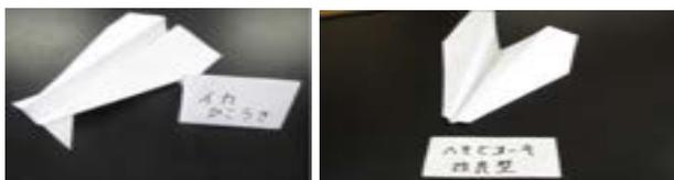
へそ,イカ,矢B,矢Cの四種類をA4サイズのコピー用紙,和紙,画用紙で作成し5回ずつ発射台を用いて飛ばし距離を計測する。(明らかに飛ばなかった場合と逆向きに飛んだ場合はカウントしない)
