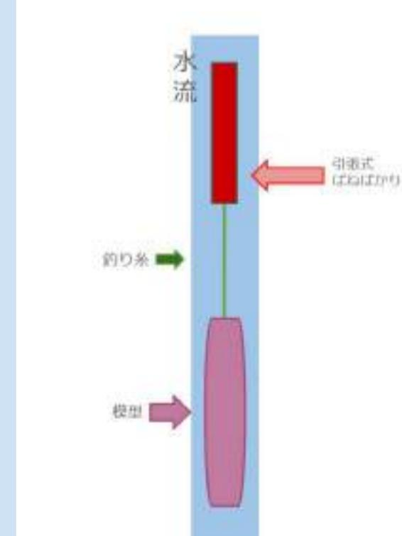
本研究では流体模型に加わる抵抗について研究し、模型の傾斜が大きいと水の抵抗が大きくなるという成果を得ることができた。一方で、風洞を用いた実験のデータ不足や移動距離の変化の詳細な分析が課題として残された。今後は、追加のデータ収集や回流水槽を取り入れ、空気を用いた実験の精度向上を図る予定である。
