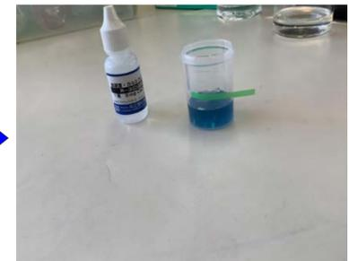
・硬度ドロップテストを用いた湧水の硬度
