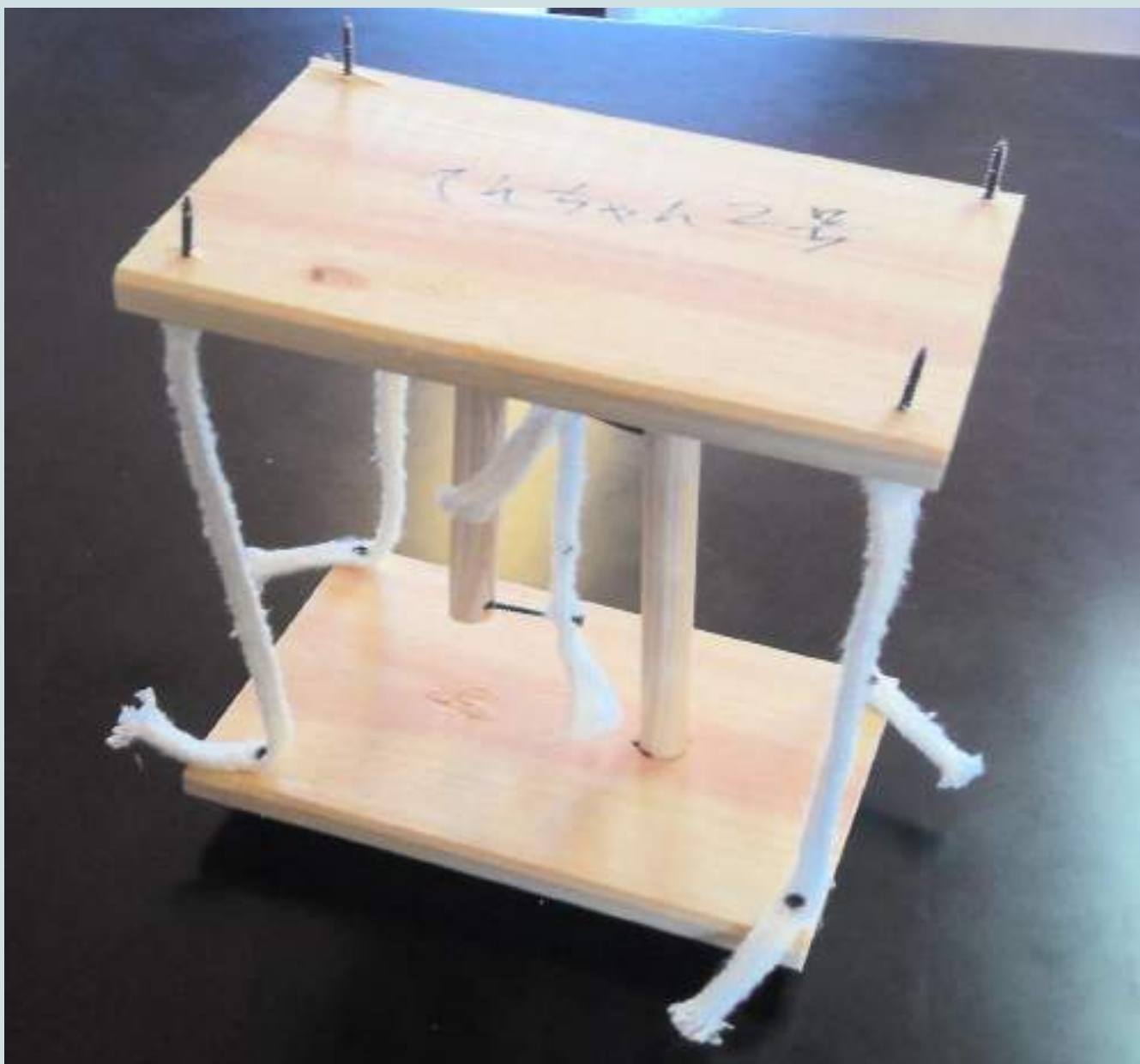
初期に自作したテンセグリティ構造たち 左:麻紐、プラストロー 右:毛糸、木板
