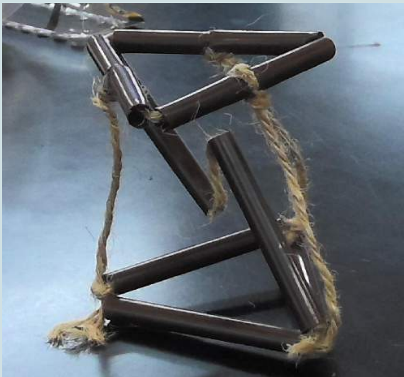
初期に自作したテンセグリティ構造たち 左:麻紐、プラストロー 右:毛糸、木板
