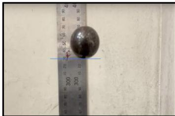
**実験①** どれだけ跳ね返るのか計測する。(図1)
