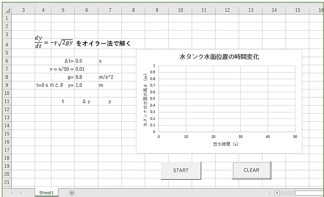
図 5-4 START で 1m の高さの水面が下がっていく。
