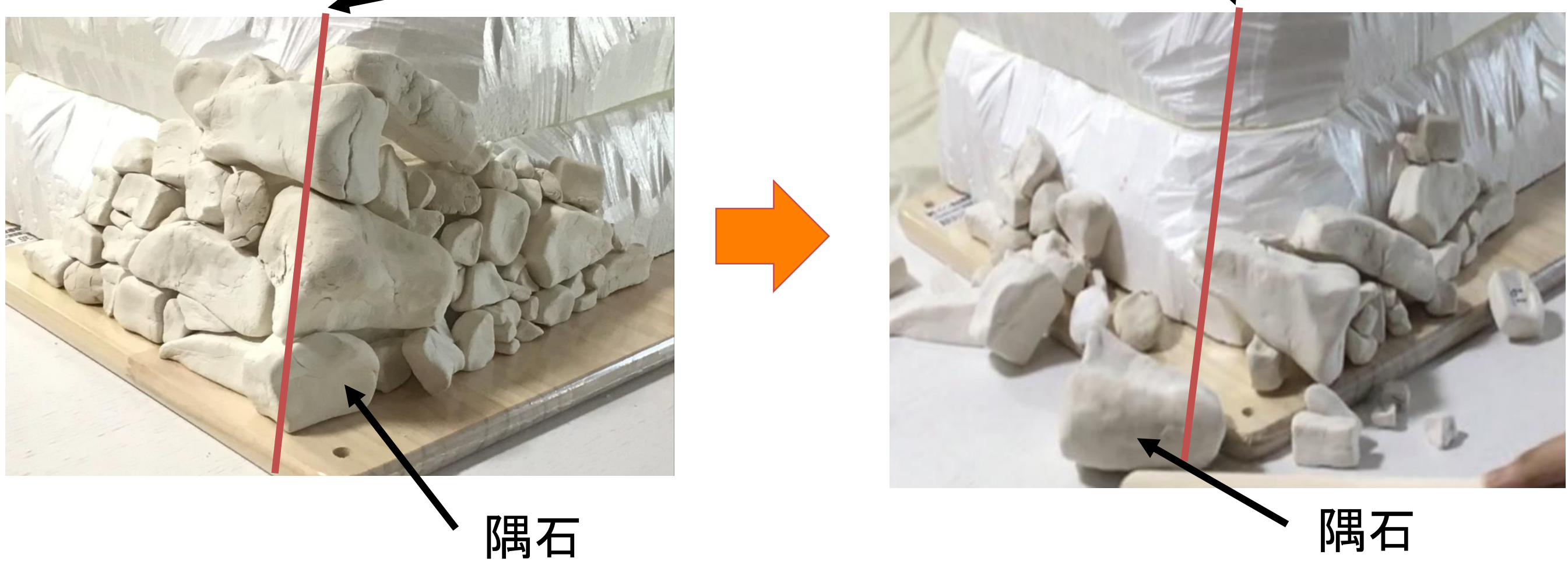
図VII 粘土モデルの崩壊実験 右に湾曲させて積み隅石をとるとモデルの石の多くが右へ崩れていく。
