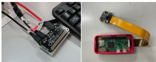
Fig.3 RaspberryPiZeroWH に Enviro pHAT (左) とカメラモジュール (右) を装着したもの
