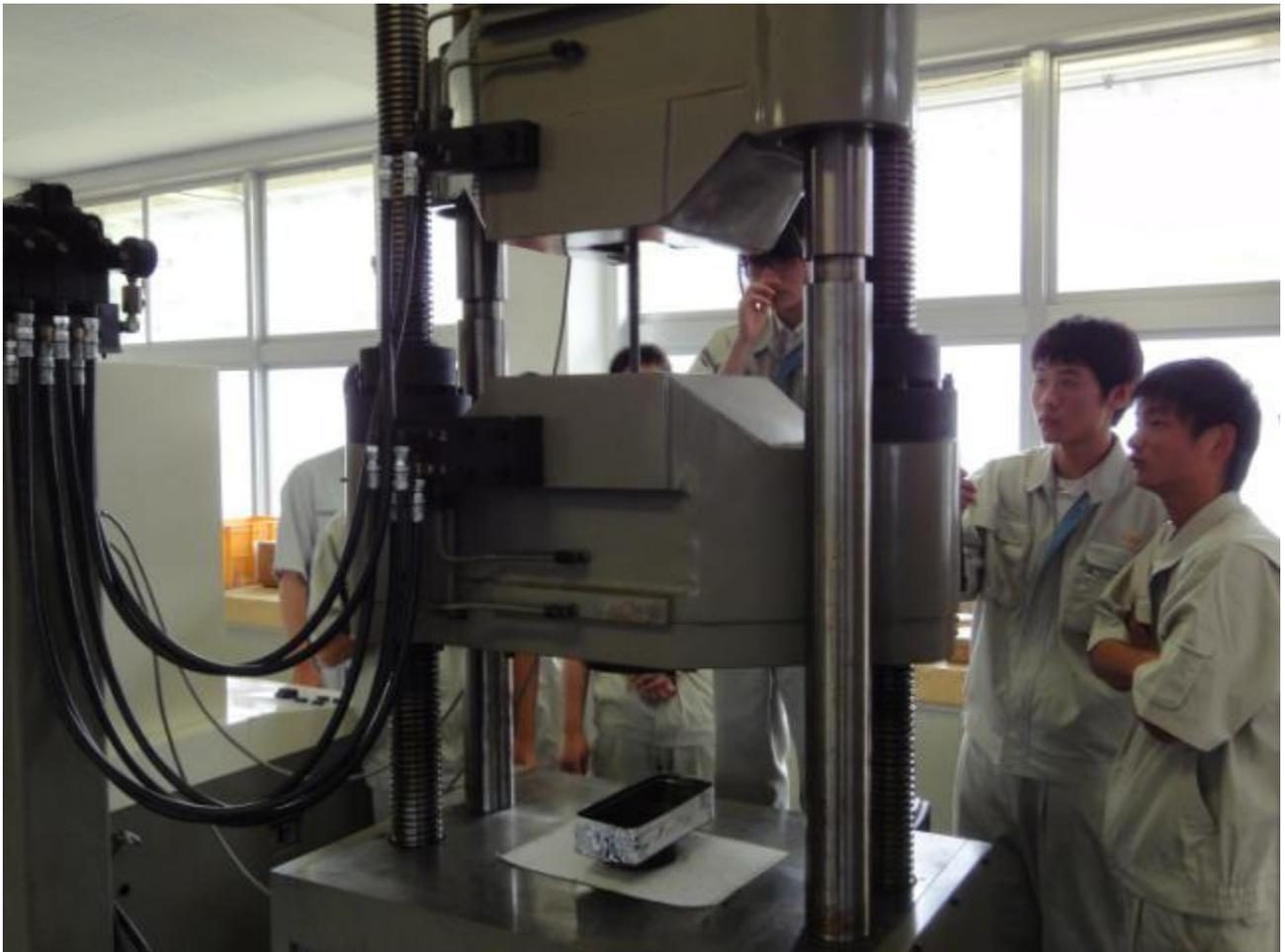
鉄筋の引っ張りの強度を調べる実験中でした。約90Nニュートン（ $\times 9.8 = \text{約}900\text{kg}$ ）の力まで引っ張って、約20分で、「ボン」という音とともに、千切れました。下がその直後の写真。
