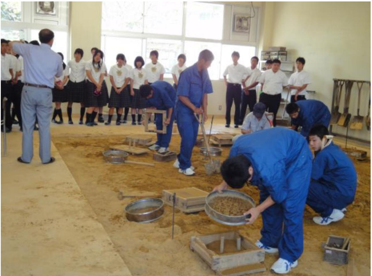
鑄造の実習では、金属を流し込むための鑄型を、細かい砂をふるって作成しているところを見学しました。その他、機械科の実習には、農業機器の修理等に役立つものもあり、関心を持ったと思います。
