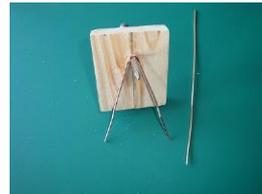
4 板と銅線をしっかり固定し机の上などに押し付け直角に曲げる。
