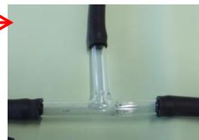
② 下腕のストローにはゴム管と空気入れを取り付ける。
